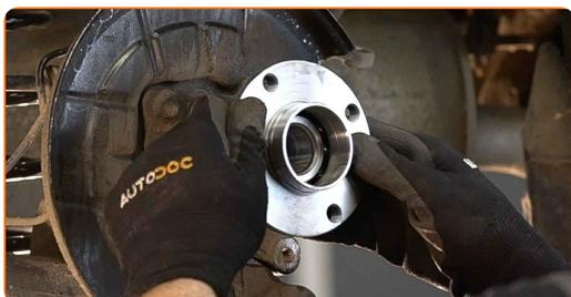
**21** Aperte o cubo. Use uma chave soquete nº 32. Use uma chave de torque. Aperte-o para o torque de 224 Nm.
