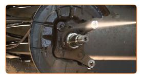
20 Instale o novo cubo da roda com um rolamento.
