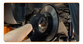
Aperte a fixação do disco de travão. Use uma chave soquete nº 12. Use uma chave de torque. Aperte-o para o torque de 10 Nm.
