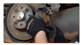
Limpe os fixadores do suporte da pinça de travão. Use uma escova metálica. Use spray WD-40.
