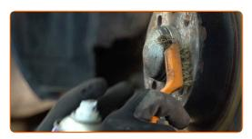
Desaperte a fixação do disco de travão. Use uma chave soquete nº 12. Use uma chave de catraca.
