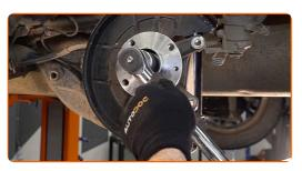
Substituição: rolamento da roda – FIAT Panda Hatchback (312\_, 319\_). Conselho:
