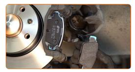
Instale a pinça do travão e fixe-o. Use uma chave soquete nº 13. Use uma chave de torque. Aperte-o para o torque de 30 Nm.
