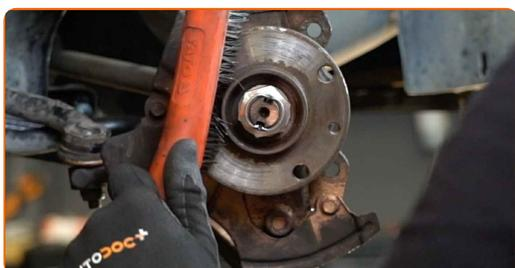
**20** Limpe a superfície do disco de travão. Use o spray de limpeza universal.
