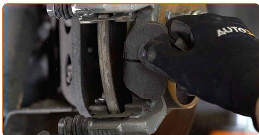
**11** Limpe os fixadores do suporte da pinça de travão. Use uma escova metálica. Use spray WD-40.
