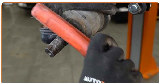
**52** Limpe o elemento de fixação que conecta o terminal de direção à manga de eixo. Use uma escova metálica. Use spray WD-40.
