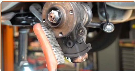
**68** Trate o fixador do sensor de ABS. Use um lubrificante multiusos.
