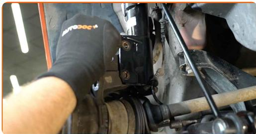
**56** Instale os parafusos de fixação.
