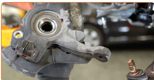
**39** Limpe a fixação do cubo da roda. Use uma escova metálica. Use spray WD-40.
