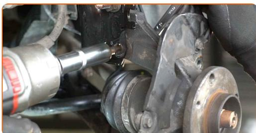
**58** Instale o parafuso de fixação.
