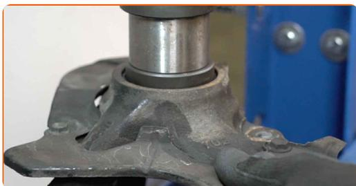
**46** Limpe o local de montagem do rolamento de cubo. Use uma escova metálica. Use spray WD-40.
