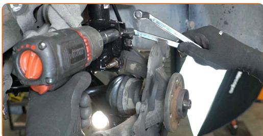
**35** Retire os parafusos de fixação.
