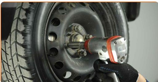
**35** Baixe o carro e trabalhe em ordem transversal, apertar os parafusos das rodas. Use uma chave de torque. Aperte-o para o torque de 98 Nm.
