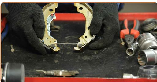
**21** Conecte o cabo do travão de mão à alavanca do travão de estacionamento.
