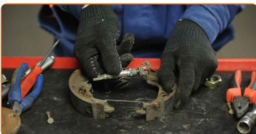
**20** Instale as molas de retenção superiores e o mecanismo de ajuste nos novos calços dos travões.
