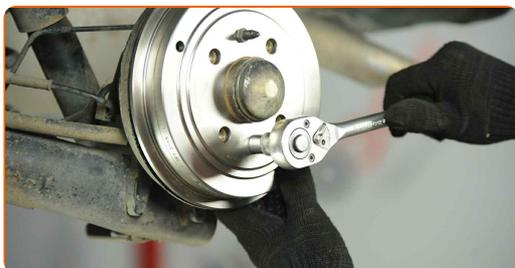
**32** Limpe o local de montagem do aro do pneu. Use uma escova metálica. Trate da superfície onde a jante da roda entra em contacto com o tambor de travão. Use massa de cobre.
