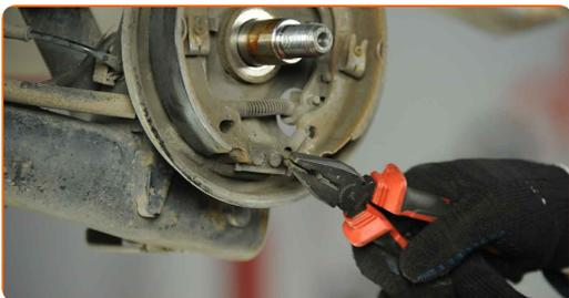
**14.1** Remova a copela de fixação das sapatas de travão.
