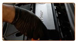
Aparafusar os parafusos de fixação da tampa do filtro de ar. Use uma chave soquete nº 7. Use uma chave de catraca.
