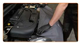
Desaperte os parafusos de fixação da tampa do filtro de ar. Use uma chave soquete nº 7. Use uma chave de catraca.
