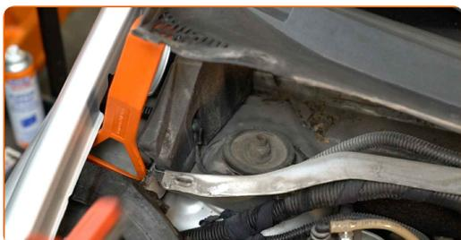
**7** Limpe os fixadores da montagem superior do suporte do amortecedor. Use uma escova metálica. Use spray WD-40.
