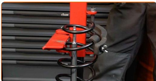
**36** Instale a manga para poeiras e a bomba de bloqueio no novo amortecedor.
