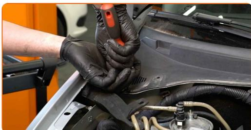
**64** Instale os fixadores da carenagem da grelha de plástico do limpa para-brisas.
