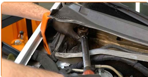
**61** Trate os fixadores do apoio da coluna de suspensão. Use massa de cobre.
