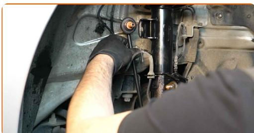
**12** Desaparafuse o fixador que conecta bieleta da barra estabilizadora à barra estabilizadora. Use uma chave soquete nº 17. Use uma chave de torque. Aperte-o para o torque de 50 Nm.
