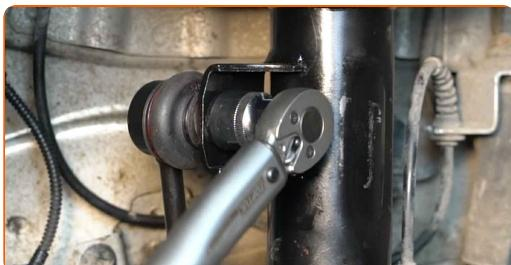
**13** Aperte o fixador que conecta a bieleta da barra estabilizadora à barra estabilizadora. Use uma chave soquete nº 17. Use uma chave de torque. Aperte-o para o torque de 50 Nm.
