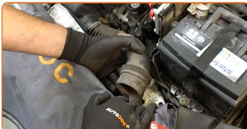
**4** Desaperte os parafusos de fixação da tampa do filtro de ar. Use uma chave soquete nº 10. Use uma chave de catraca.
