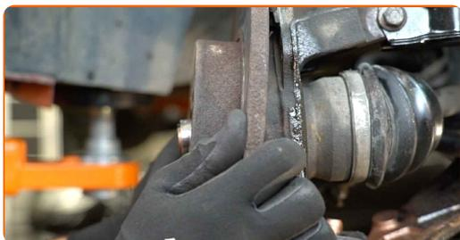
**19** Limpe o cubo. Use uma escova metálica. Trate a superfície de contacto. Use massa de cobre.
