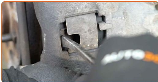
**9** Remova o clipe de retenção do pino de bloqueio. Use alicates de ponta arredondada.
