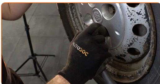
**22** Baixar o carro e trabalhar em ordem transversal, apertar os parafusos das rodas. Use uma chave de torque. Aperte-o para o torque de 98 Nm.
