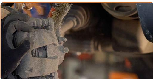
**8** Desaparafuse a fixação de pinça de travão. Use uma chave soquete nº 13. Use uma chave de catraca.
