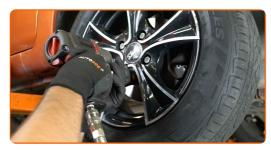
Baixar o carro e trabalhar em ordem transversal, apertar os parafusos das rodas. Use o soquete de impacto para roda #17. Use uma chave de torque. Aperte-o para o torque de 98 Nm.
