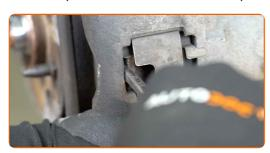
Remova o clipe de retenção do pino de bloqueio. Use alicates de ponta arredondada.
