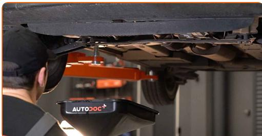
**8** Limpe a área do orifício de drenagem do cárter. Use o spray de limpeza universal.
