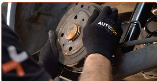
**18** Aperte os fixadores do tambor de travão. Use uma chave soquete nº 12. Use uma chave de torque. Aperte-o para o torque de 15 Nm.
