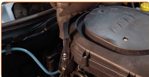
**23** Instale a mola de retenção do corpo do filtro de ar.
