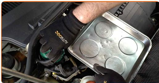
6 Desaperte a tampa da caixa do filtro em conjunto com o antigo elemento do filtro. Coloque o cartucho do filtro antigo no recipiente.
