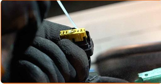
**14** Conecte o conector do sensor de pressão do combustível.
