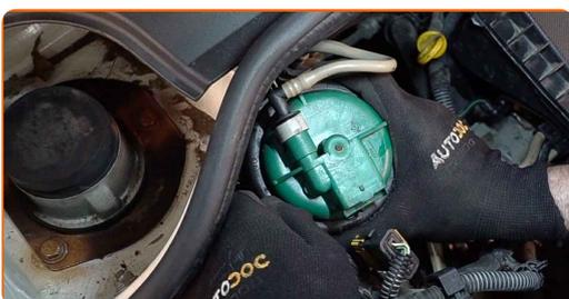
**13** Limpe o conector do sensor de pressão de combustível. Use spray eletrônico.
