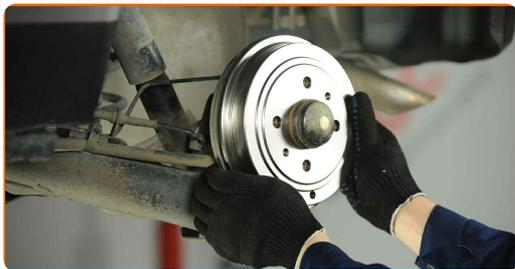
**14** Aperte os fixadores do tambor de travão. Use uma chave soquete nº 12. Use uma chave de torque. Aperte-o para o torque de 15 Nm.
