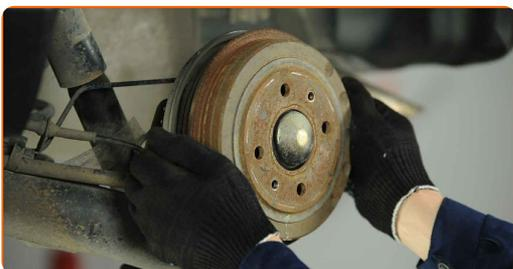
**11** Retire a tampa de proteção de rolamento de cubo. Use uma chave de fenda plana. Use um martelo.
