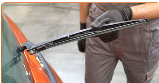
**3** Pressione o clipe de fixação. Use uma chave de fenda plana.
