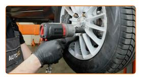
Baixar o carro e trabalhar em ordem transversal, apertar os parafusos das rodas. Use o soquete de impacto para 33 roda #19. Use uma chave de torque. Aperte-o para o torque de 95 Nm.
