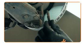
Desaperte o fixador traseiro que liga o braço da suspensão ao subchassi. Use uma chave soquete nº 13. Use uma chave soquete nº 18. Use uma chave de tarraxa.
