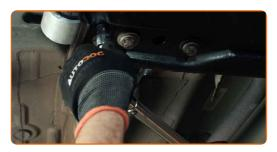
Aperte o fixador traseiro do braço da suspensão. Use uma chave soquete nº 18. Use uma chave de torque. Aperte-o para o torque de 80 Nm.+55°
