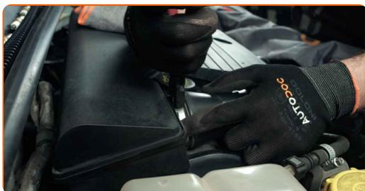
**24** Conecte o tubo de entrada de ar ao compartimento do filtro de ar.
