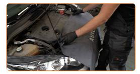
Desaperte os parafusos de fixação da tampa do filtro de ar. Use uma chave soquete nº 10. Use uma chave de catraca.
