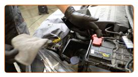
Insira um novo elemento de filtro na caixa do filtro. Certifique-se de que a borda do filtro encaixa-se perfeitamente na caixa.
