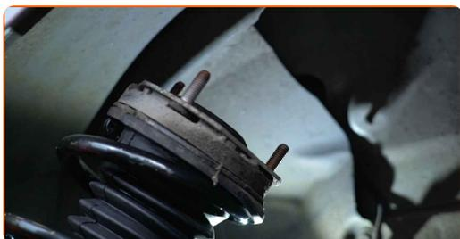
**42** Aparafuse a fixação superior de montagem do suporte do amortecedor. Não o aperte.
