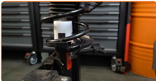
**40** Trate dos assentos de montagem do amortecedor. Use uma escova metálica. Use spray WD-40.
