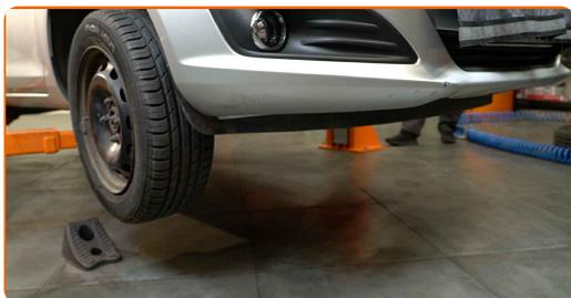
**8** Desaperte os parafusos da roda.
