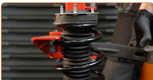
**38** Trate a haste da coluna do amortecedor. Use massa de cobre.
