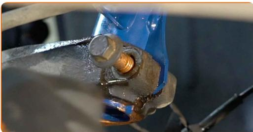
**55** Aparafuse o fixador que conecta o amortecedor à manga de eixo. Use uma chave soquete nº 15. Use uma chave de catraca.
