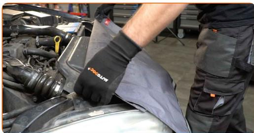
**3** Separe a cablagem do motor. Use uma chave de fenda plana.
