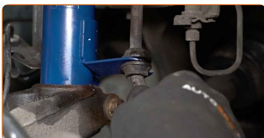
**72** Trate os fixadores do amortecedor. Use massa de cobre.
