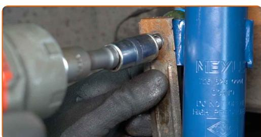
**70** Desaparafuse o fixador que conecta bieleta da barra estabilizadora à barra estabilizadora. Use uma chave soquete nº 15. Use uma chave de torque. Aperte-o para o torque de 50 Nm.
