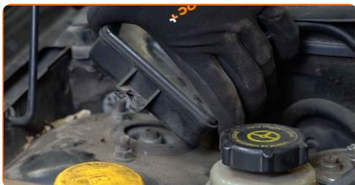
**4** Limpe os fixadores do suporte superior do amortecedor. Use uma escova metálica. Use spray WD-40.
