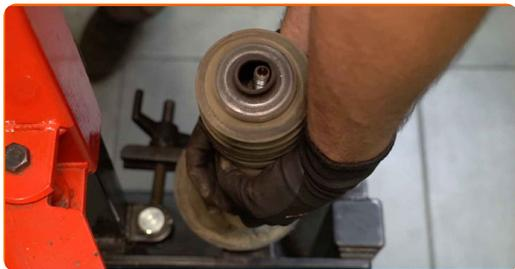
**40** Instale a coifa e o batente de encosto no amortecedor.
