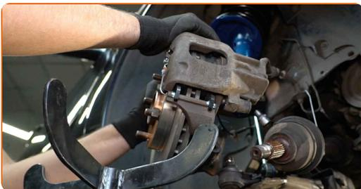
**54** Instale o parafuso de fixação.
