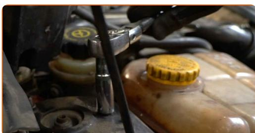
**6** Limpe os fixadores do eixo motor. Use uma escova metálica. Use spray WD-40.
