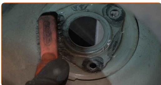
**49** Instale o amortecedor no arco da roda.
