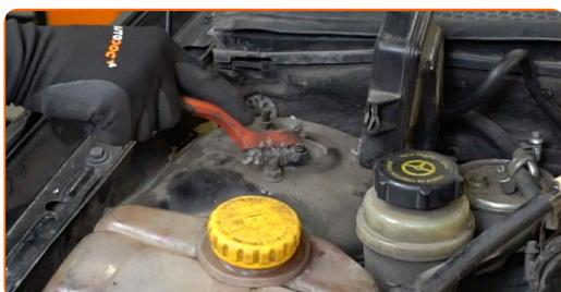
**5** Solte os fixadores superiores do dispositivo amortecedor (3 peças). Use uma chave soquete nº 13. Use uma chave de catraca.
