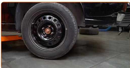
**79** Aperte a porca do eixo de transmissão. Use uma chave soquete nº 32. Use uma chave de torque. Aperte-o para o torque de 275 Nm.
