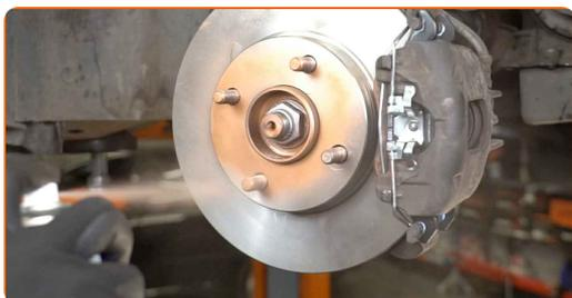
**75** Limpe a superfície do disco de travão. Utilize um produto de limpeza para travões.
