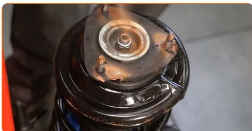
**47** Retire a coluna de suspensão montada.
