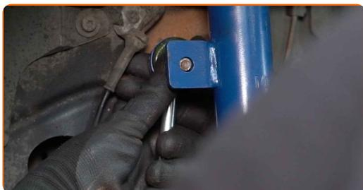
**69** Aperte o fixador da bieleta da barra estabilizadora. Use uma chave combinada nº 15. Use uma chave soquete nº 15. Use uma chave de catraca.
