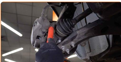
9 Desaperte a fixação da braçadeira da pinça. Use uma chave soquete nº 14. Use uma chave de tarraxa. Use uma chave de catraca.
