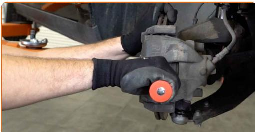
**8** Limpe os fixadores do suporte da pinça de travão. Use uma escova metálica. Trate os fixadores do suporte da pinça de travão. Use spray WD-40.
