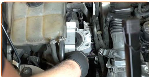
**14** Aperte os parafusos de fixação do apoio do motor. Use uma chave soquete nº E11. Use uma chave de torque. Aperte-o para o torque de 32 Nm.
