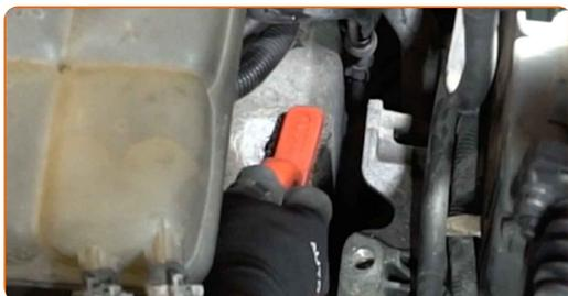
**13** Instale o apoio do motor no seu assento de montagem.
