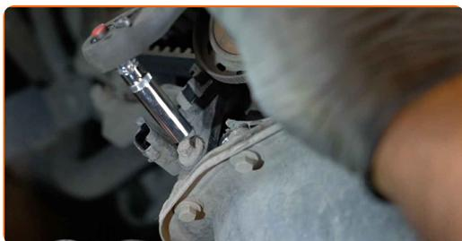
**40** Retire o sensor de posição da cambota.
