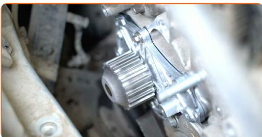
**76** Aperte os fixadores da bomba de água. Use uma chave soquete nº 8. Use uma chave de torque. Aperte-o para o torque de 10 Nm.
