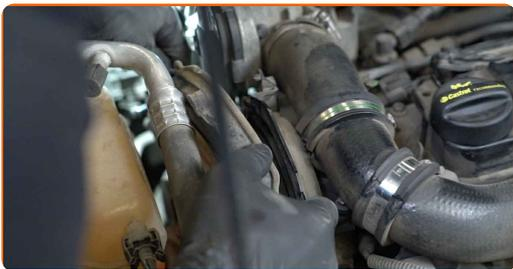
**9** Desaparafuse os fixadores da cobertura inferior da correia poly-V. Use Torx T30. Use uma chave de catraca.
