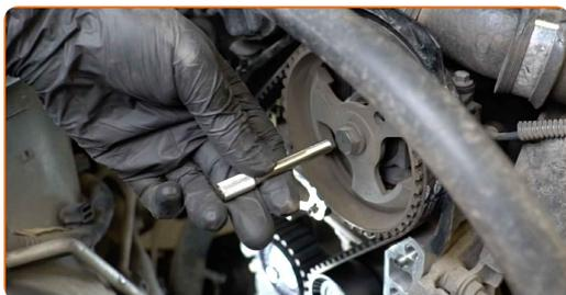
**87** Remova a peça de bloqueio da engrenagem da árvore de cames.
