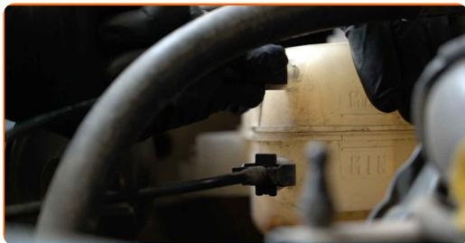
**118** Limpe o local de montagem do tubo inferior do líquido de refrigeração. Use o spray de limpeza universal.
