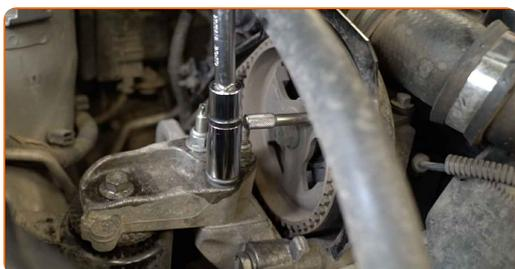
**61** Desaperte os fixadores de apoio do motor. Use uma chave soquete nº 16. Use uma chave de catraca.
