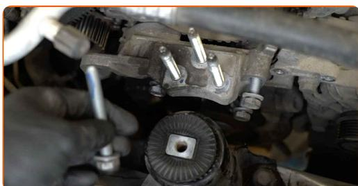
**93** Aperte os parafusos de fixação do apoio do motor. Use uma chave soquete nº 16. Use uma chave de torque. Aperte-o para o torque de 55 Nm.
