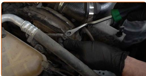
**7** Desaparafuse os fixadores da cobertura superior da correia de distribuição. Use uma chave soquete nº 7. Use uma chave de catraca.
