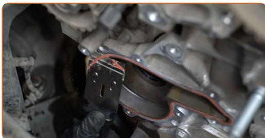
**74** Instale a junta da bomba de água.
