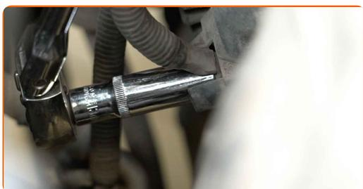
**132** Instale a tampa no elemento fixador da cablagem do alternador.
