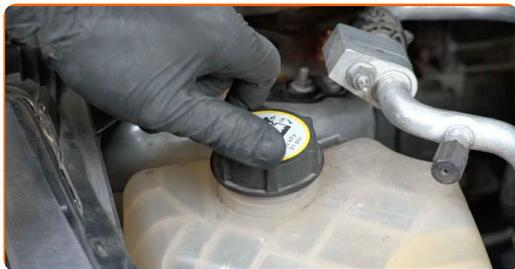
**149** Enrosque a tampa do depósito do líquido de refrigeração.
