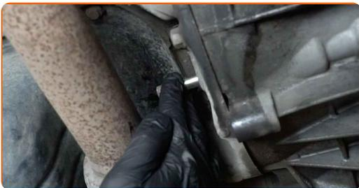
**55** Vire a engrenagem da cambota. Use uma chave soquete nº 18. Use uma chave de catraca.
