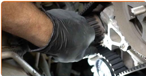
**88** Remova a peça de bloqueio da engrenagem da cambota.
