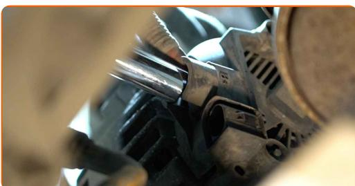
**18** Retire a cablagem do alternador.
