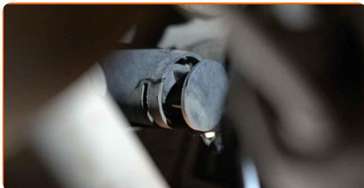
**44** Remova o clipe de retenção do bужão de escoamento do líquido de refrigeração.
