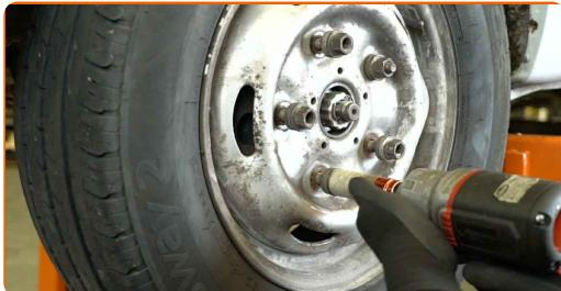
**31** Baixar o veículo e apertar as porcas da roda em cruz. Utilizar uma chave de impacto de 21 mm para rodas. Utilizar uma chave dinamométrica. Binário de aperto: 200 N·m.
