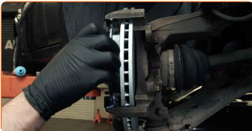
**25** Instale a pinça do travão e fixe-o. Use HEX n.º H7 Use uma chave de torque. Aperte-o para o torque de 30 Nm.
