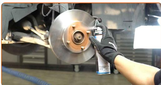
**28** Limpe a superfície do disco de travão. Utilize um produto de limpeza para travões.
