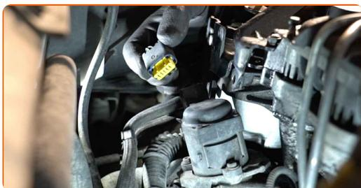
**6** Remova a braçadeira de fixação da mangueira da válvula EGR. Utilize alicates de anel clic-R.
