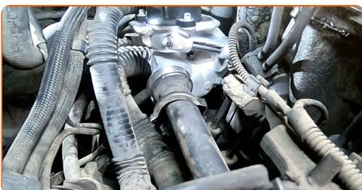
**15** Instale a braçadeira de fixação da mangueira da válvula EGR. Utilize alicates de anel clic-R.
