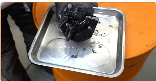
**12** Desaparafuse os fixadores da capa da carcaça do filtro de combustível. Use Torx T15. Use uma chave de catraca.
