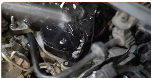
**26** Aperte os parafusos de fixação do suporte do filtro de combustível. Use uma chave soquete nº 8. Use uma chave de catraca.
