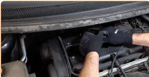
Substituição: vela de ignição – FORD Focus C-Max (DM2). Conselho:
