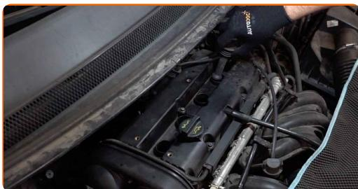
Substituição: vela de ignição – FORD Focus C-Max (DM2). AUTODOC recomenda:
