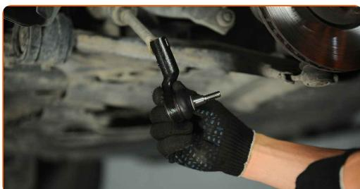
**Substituição: terminal de direção – FORD Focus C-Max (DM2). Conselho de especialistas da AUTODOC:**
