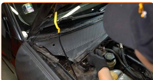
12 Aparafuse os elementos de fixação da grelha do limpa para-brisas localizada no lado direito. Use a chave Phillips.
