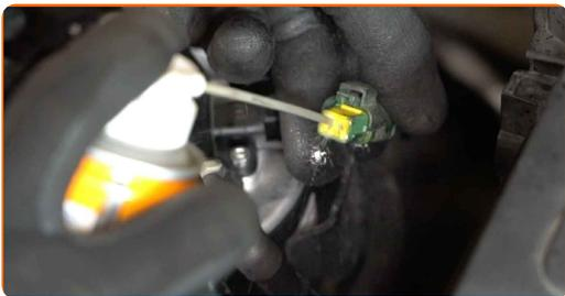
**15** Conecte o conector do sensor de pressão do combustível.
