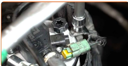
**14** Limpe o conector do sensor de pressão de combustível. Use graxa dielétrica.
