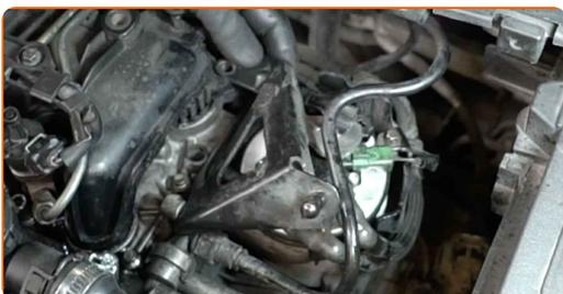
**17** Aperte os parafusos de fixação do suporte do filtro de combustível. Use uma chave soquete nº 10. Use uma chave de catraca.
