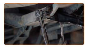
Aperte os fixadores que conectam o braço de controlo à manga traseira. Use uma chave soquete nº 18. Use uma chave de torque. Aperte-o para o torque de 115 Nm.
