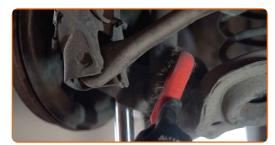
Desaperte a fixação inferior do amortecedor. Use uma chave soquete nº 16. Use uma chave de catraca.
