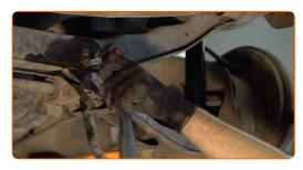
Instale um novo braço de suspensão. Instale os fixadores do braço de controlo.
