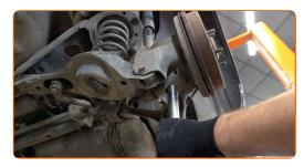
Limpe os elementos de fixação do amortecedor. Use uma escova metálica. Use spray WD-40.
