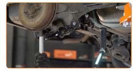
Limpe o local de montagem do aro do pneu. Use uma escova metálica. Trate a superfície de contacto. Use massa de cobre.
