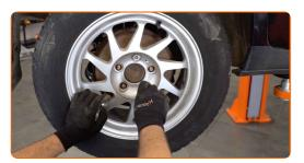
Baixar o carro e trabalhar em ordem transversal, apertar os parafusos das rodas. Use uma chave de torque. Aperte-o para o torque de 110 Nm.
