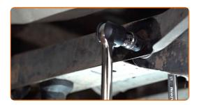
Desaparafuse o fixador que conecta o braço de controlo à manga traseira. Use uma chave soquete nº 18. Use uma chave de catraca. Remova o parafuso de fixação.
