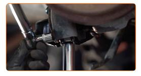
Instale o terminal do estabilizador transversal.
