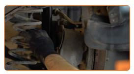
Remova a fixação do braço inferior. Remova o parafuso de fixação.
