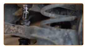
Faça uma marca na travessa e no parafuso de ajuste da cambagem positiva. Use um cinzel plano para metal.
