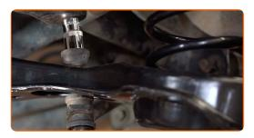
Aperte a fixação inferior do amortecedor. Use uma chave soquete nº 16. Use uma chave de torque. Aperte-o para o torque de 103 Nm.
