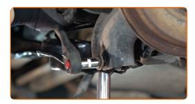
Aperte a fixação do braço na barra. Use uma chave soquete nº 18. Use uma chave combinada nº 19. Use uma chave de torque. Aperte-o para o torque de 90 Nm.
