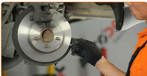
**23** Instale os parafusos de fixação (2 peças).
