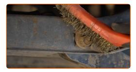
Desaperte os parafusos de fixação da barra estabilizadora. Use uma chave combinada nº 15. Use uma chave soquete nº 15. Use uma chave de catraca.
