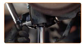
Instale o terminal do estabilizador transversal.
