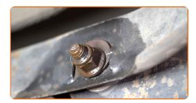
Desaparafuse a fixação do braço da barra. Use uma chave soquete nº 18. Use uma chave combinada nº 19. Use uma chave de tarraxa.
