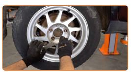
Baixar o carro e trabalhar em ordem transversal, apertar os parafusos das rodas. Use o soquete de impacto para roda #19. Use uma chave de torque. Aperte-o para o torque de 110 Nm.
