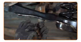
Aperte o fixador da bieleta da barra estabilizadora. Use uma chave combinada nº 15. Use uma chave soquete nº 15. Use uma chave de torque. Aperte-o para o torque de 15 Nm.
