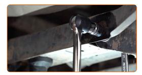
Desaparafuse o fixador que conecta o braço de controlo à manga traseira. Use uma chave soquete nº 16. Use uma chave de catraca. Remova o parafuso de fixação.
