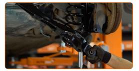
Aparafuse os fixadores que conectam o braço de controlo à manga traseira. Use uma chave soquete nº 16. Use uma chave de catraca.
