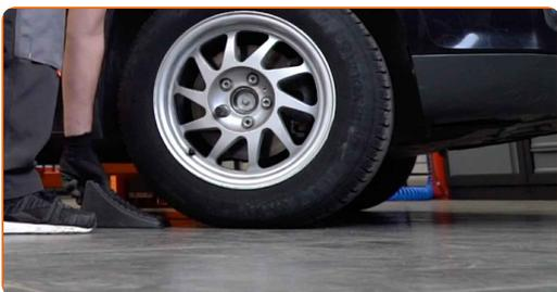
**13** Solte os parafusos de montagem das rodas. Use o soquete de impacto para roda #19.
