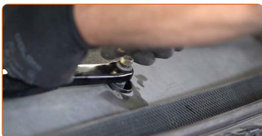
Substituição: cabeçotes do amortecedores – FORD Focus II Hatchback (DA\_, HCP, DP). Conselho:
