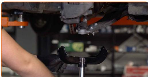
**22** Solte o fixador inferior que conecta a coluna de suspensão às mangas de eixo. Use uma chave especial para remover o amortecedor. Use um martelo. Use um cinzel plano para metal.
