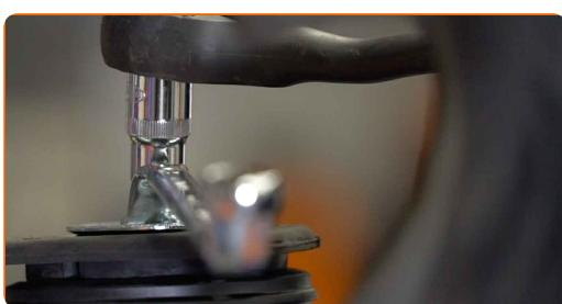
**Substituição: cabeçotes do amortecedores – FORD FOCUS III. Conselho da AUTODOC:**
