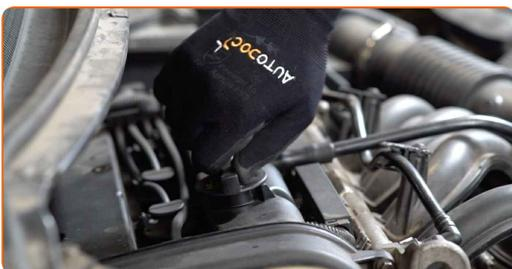
**23** Ligue o motor por alguns minutos. Após a luz de advertência da pressão do óleo se apagar, desligue o motor.
