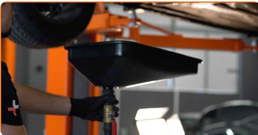
8.1 Desaperte o bujão de drenagem. Use uma chave soquete nº 13. Use uma chave de catraca.
