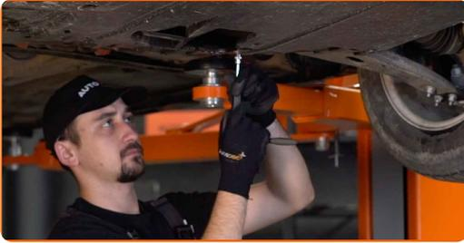
6 Remova a tampa do cárter de óleo. Use uma chave soquete nº 10. Use uma chave de fenda plana. Use uma chave de catraca.
