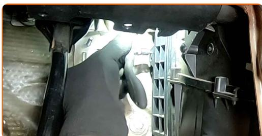
**13** Ligue o conector do pedal do acelerador.
