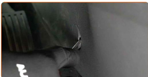
**2** Desaperte os fixadores do painel de acabamento plástico lateral. Use Torx T20.
