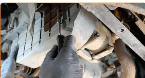
**16** Aperte os fixadores da tampa inferior do cárter. Use Torx T30. Use uma chave de catraca.
