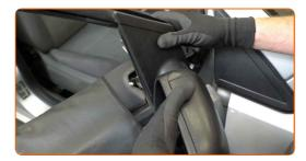
Aperte os parafusos do espelho retrovisor lateral. Use Torx T25. Use uma chave soquete nº 10. Use uma chave de torque. Aperte-o para o torque de 5 Nm.
