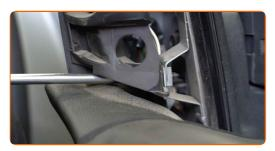
Desprenda o painel de acabamento do espelho lateral. Utilize uma ferramenta de acabamento de plástico.
