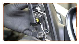
Aparafuse os fixadores do painel de revestimento do espelho retrovisor exterior. Use Torx T25.
