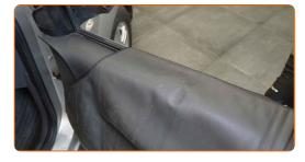
Retire a cobertura do espelho retrovisor lateral. Utilize uma ferramenta de acabamento de plástico.
