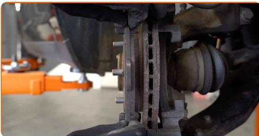
Substituição: pastilhas de travão – FORD Focus Mk3 Van / Hatchback.
