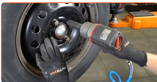
**25** Baixar o carro e trabalhar em ordem transversal, apertar os parafusos das rodas. Use o soquete de impacto para roda #19. Use uma chave de torque. Aperte-o para o torque de 110 Nm.
