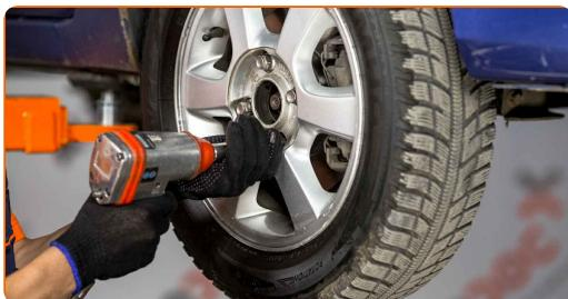
**48** Baixar o carro e trabalhar em ordem transversal, apertar os parafusos das rodas. Use o soquete de impacto para roda #19. Use uma chave de torque. Aperte-o para o torque de 95 Nm.
