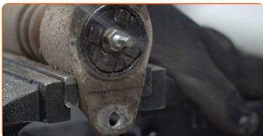
14 Retire a fixação da haste do pistão do amortecedor. Use uma chave combinada nº 13.
