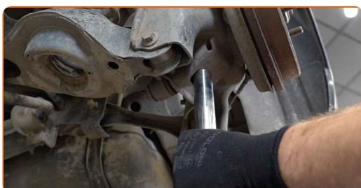
23 Aperte a fixação inferior do amortecedor. Use uma chave soquete nº 16. Use uma chave de torque. Aperte-o para o torque de 103 Nm.
