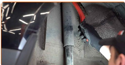
8 Desaperte a fixação do suporte do amortecedor. Use uma chave soquete nº 10. Use uma chave de catraca.
