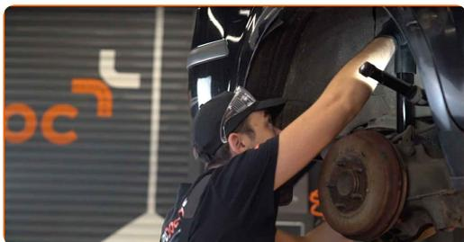
20 Instale o suporte do amortecedor usando o furo central como guia.
