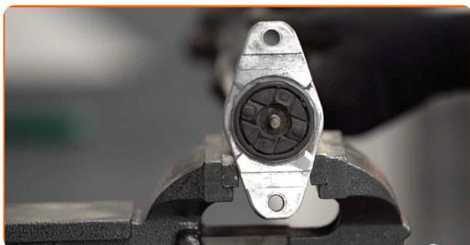
**17** Aperte a fixação superior da haste do amortecedor. Use uma chave combinada nº 13. Use uma chave soquete nº 13. Use uma chave inglesa. Use uma chave de torque. Aperte-o para o torque de 25 Nm.
