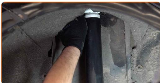
21 Aparafuse o parafuso dos suportes do amortecedor. Use uma chave soquete nº 10. Use uma chave de catraca.
