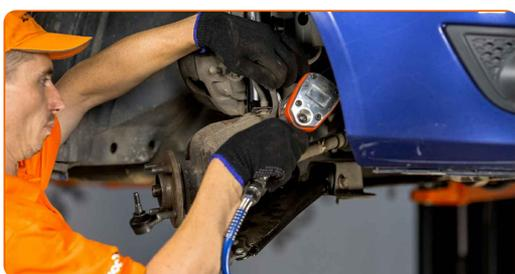
**36** Aperte o cubo. Use uma chave soquete n° 32. Use uma chave de torque. Aperte-o para o torque de 290 Nm.
